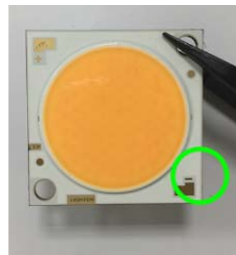
使用塑膠鑷子拿取 Use plastic tweezers
